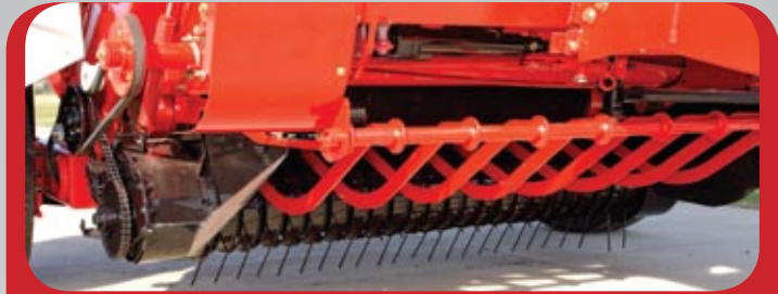
Recolector de gran capacidad con elevación hidráulica y ruedas recogedoras.
